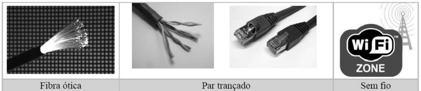
Para completar o processo de comunicação, é necessário o uso de conectores e concentradores, o conector mais usado é o RJ45, já a tecnologia sem fio não é necessário o uso de conectores.
